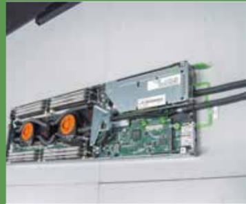
図2: Grand Chariot (サブシステムA) 計算ノードのボード
