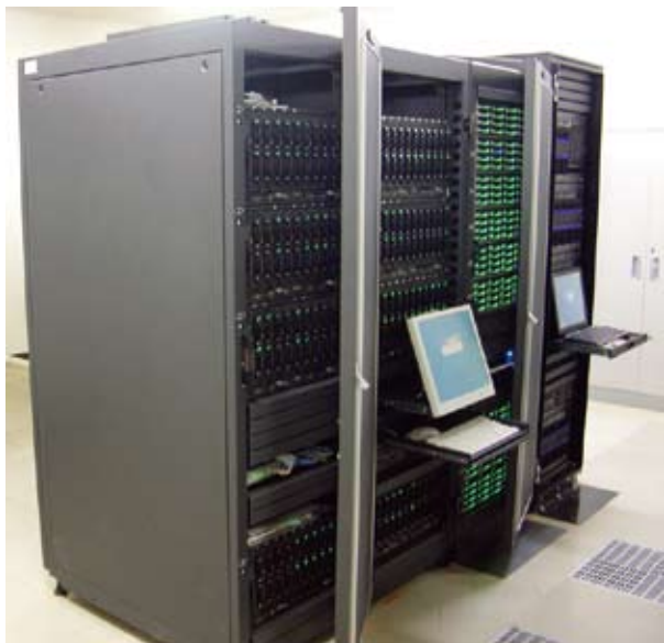
図1.プロジェクトサーバ(HITACHI BladeSymphony BS320)の外観 左側がブレード(演算ノード)80台:一列に10台あり、それがラック8段分を占めている。LEDが点灯している部分が外部ディスク装置。
