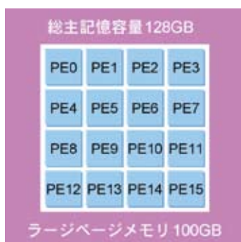
図1. バッチ処理ノードのハードウェア構成(概略)
